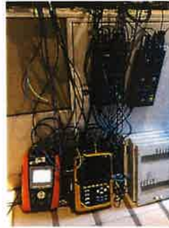
Figura 2 – Equipamentos que permitem a disponibilidade para a ação 3.1 (primeiras duas fotografias) para análise das condições de utilização dos edifícios e eficiência de utilização (condições térmicas e ambientais), além de equipamentos de medição dos consumos de energia elétrica (analísadores de energia)
